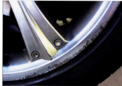
Leichte Blessuren der Felgenoberfläche sind mit dem Wheel-Doctor-System einfach zu beseitigen.
