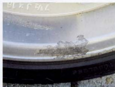
Typische Schadensbilder an Felgen, die sich mit dem WheelDoctor beheben lassen.
